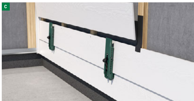
C : Poser la lame Hardie® Plank sur le dessus.
