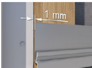
Fixation du profilé de ventilation
